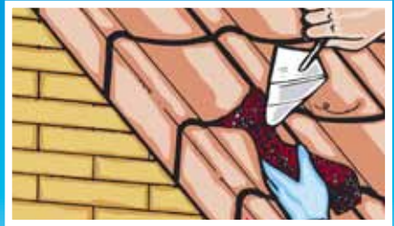
reparatie dakpan réparation de tuiles
