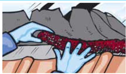
reparatie loodwerk réparation de travaux en plomb
